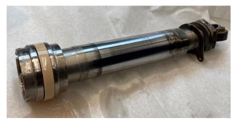
Figure 10. Right roll control actuator piston.
