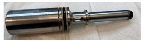
Figure 33. Left pull down actuator piston.
