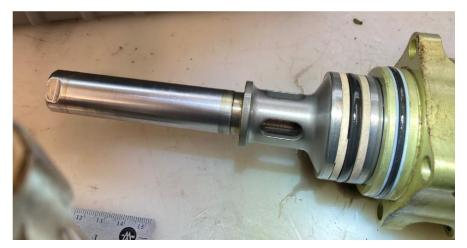
Figure 15. Right pull down actuator piston.
